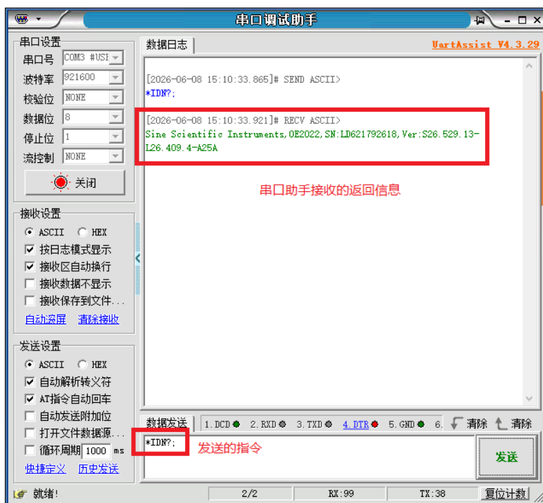
图 110. ASCII 码形式发送和接收指令
