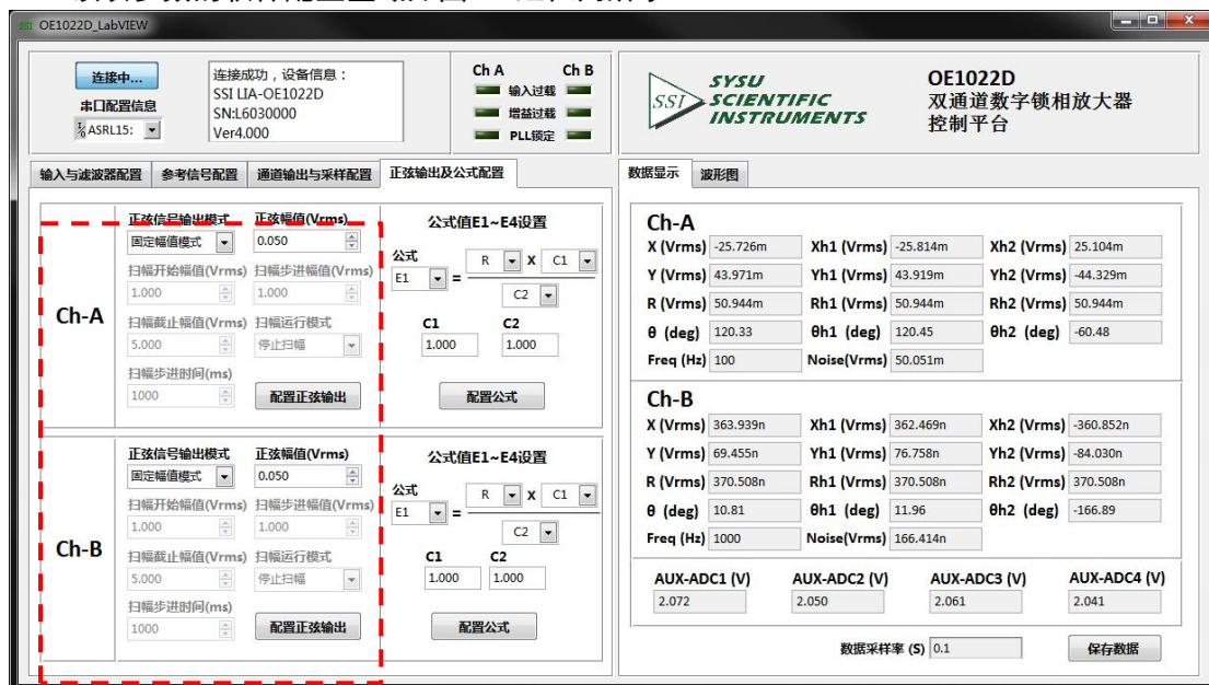
图 69. 正弦信号输出配置区域图
